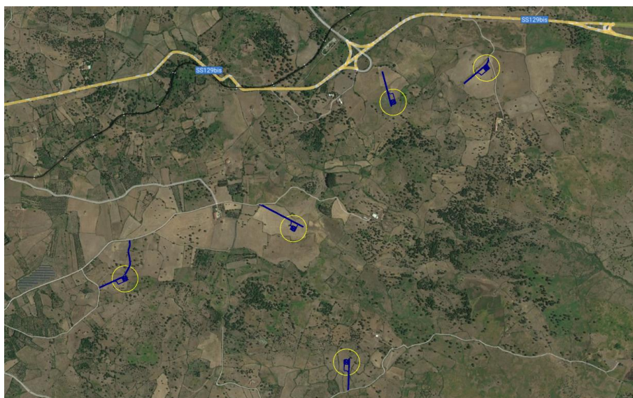
Figura: Diagramma polare puntuale di producibilità e perdita per scia su modello DTM Area impianto Ovest (Comuni di Sagama, Suni e Tinnura)
