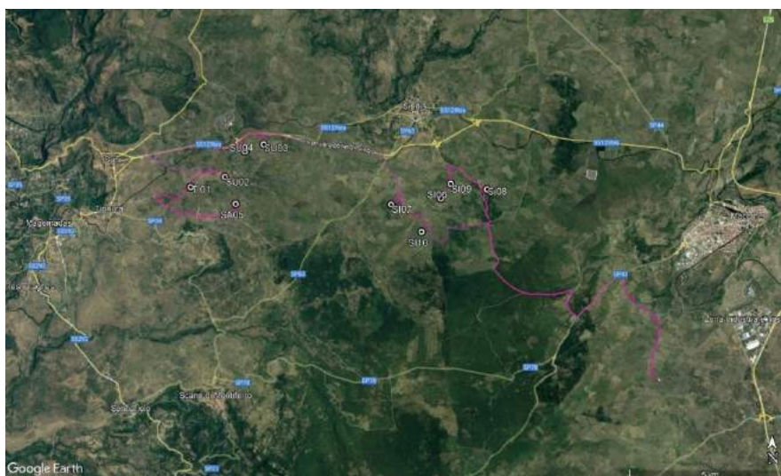
Percorso cavidotto MT interrato
