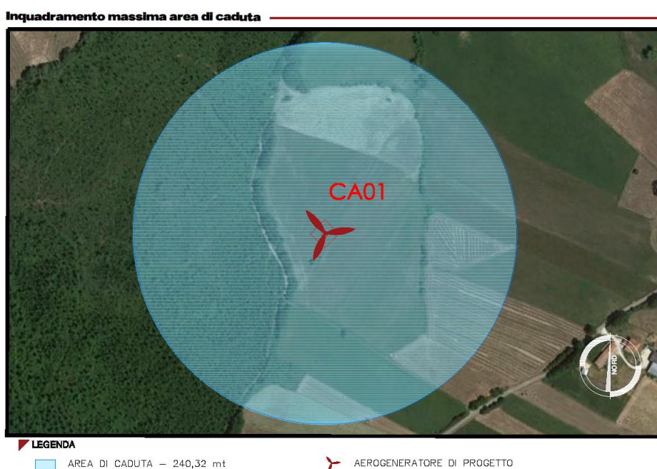
Figura 2 Massima area di caduta aerogeneratore CA01
