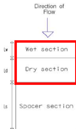
Figure 4-49: modulo tipo descrivente il modello concettuale idrologico dell'installazione di strutture fotovoltaiche a tracker su pari infissi comprendente l'area pannelli (in rosso) e l'area di interfila (Fonte: Hydrologic response of solar farm Cook 2013 American Society of Civil Engineers)
