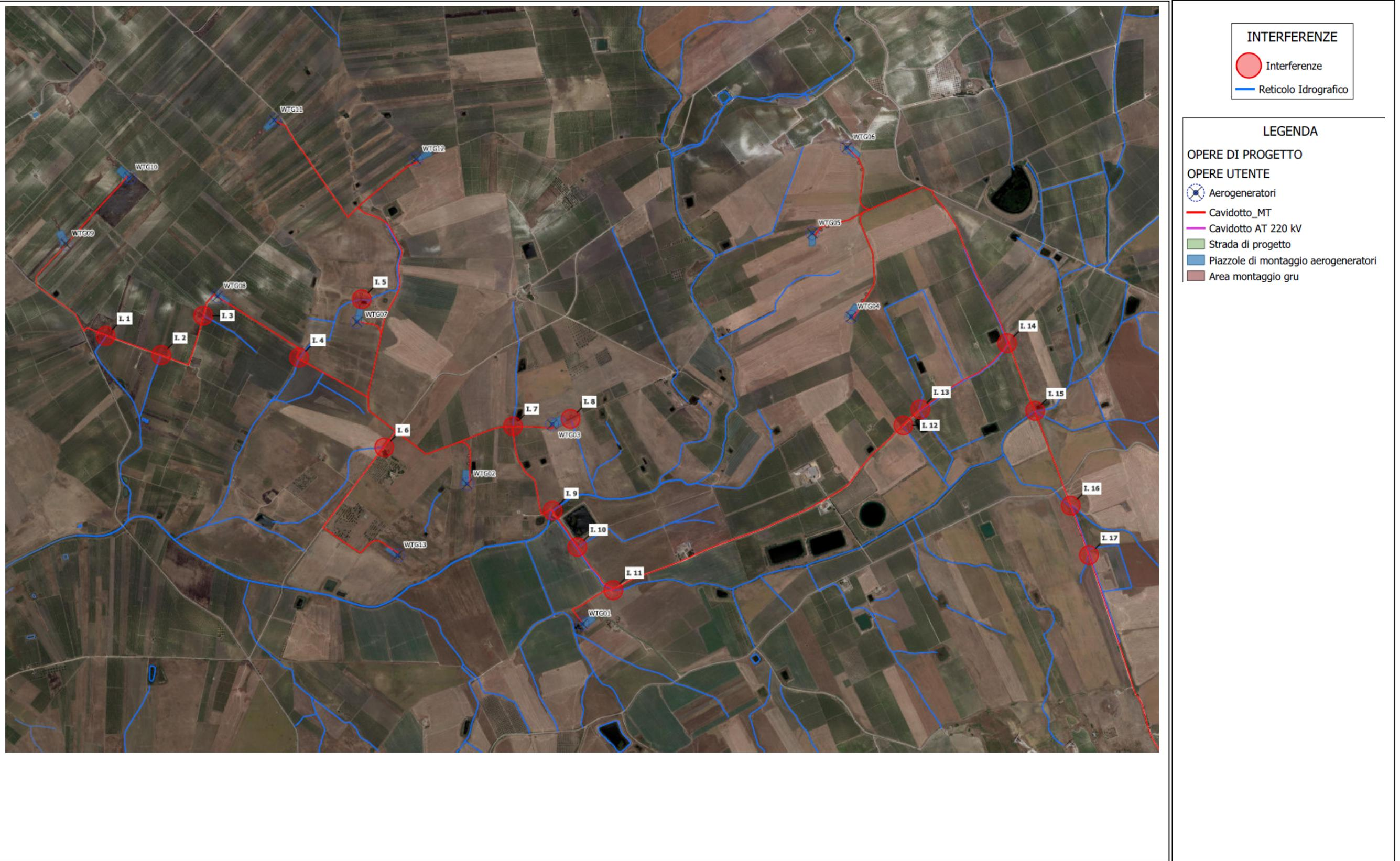
Figura 3 – Particolare Localizzazione interferenze su area di impianto
