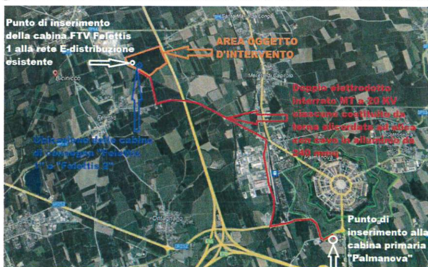
Figura 2 Vista di insieme dell’impianto di connessione con collegamento cavi MT interrati (in rosso) su base ortofoto (Cfr. Relazione paesaggistica)
