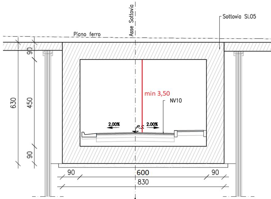
**Sezione tipo in sottopasso**
