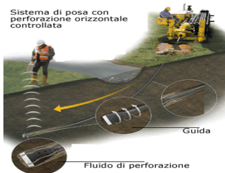
Figura 3-1 Sistema di trivellazione orizzontale controllata (T.O.C.)
