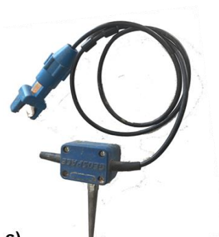
Figura 8 – geofono per onda S con frequenza caratteristica di 8 Hz.
