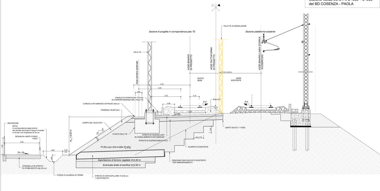
SEZIONE TIPO RILEVATO ALLEGGERITO IN AFFIANCAMENTO a singolo binario in rettilo rilevato
