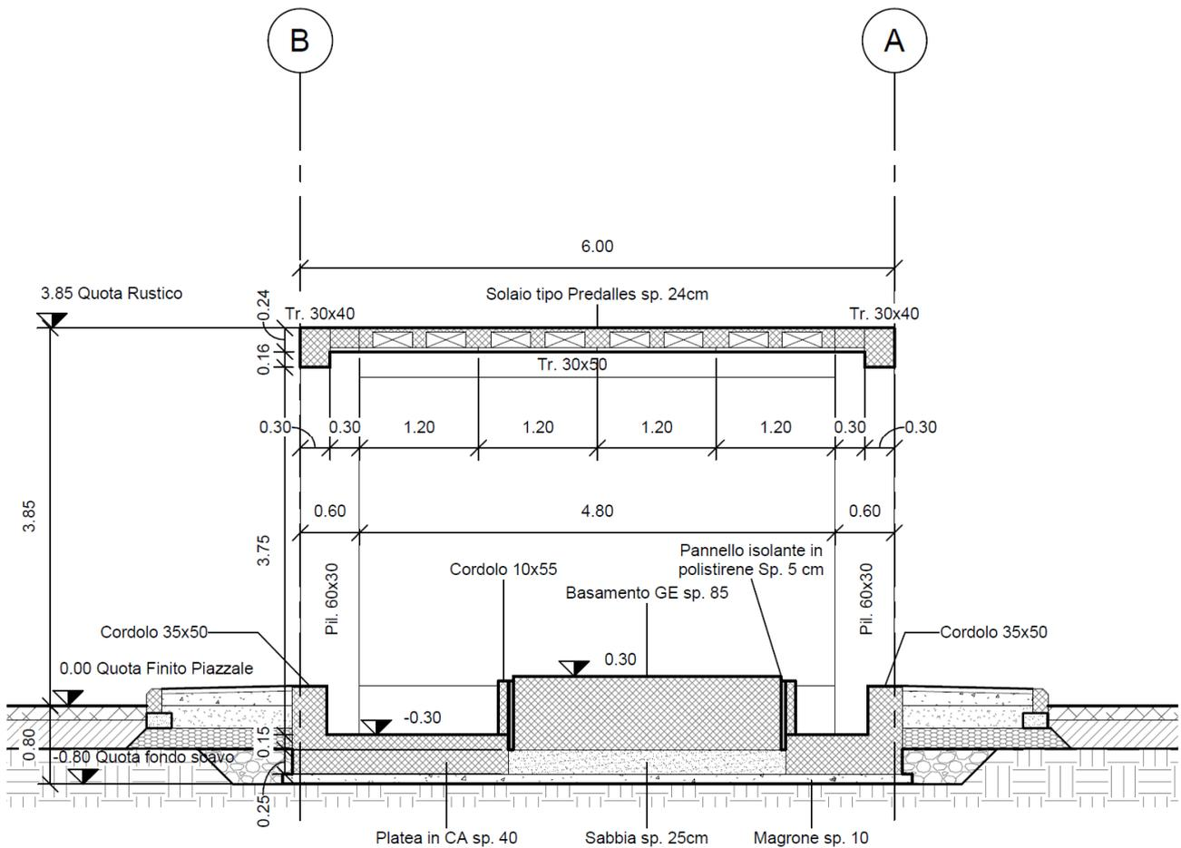
Il solaio di copertura è realizzato con un solaio predalles di spessore  $h=24$  cm. Di seguito si riporta il dettaglio tipologico del solaio in oggetto.
