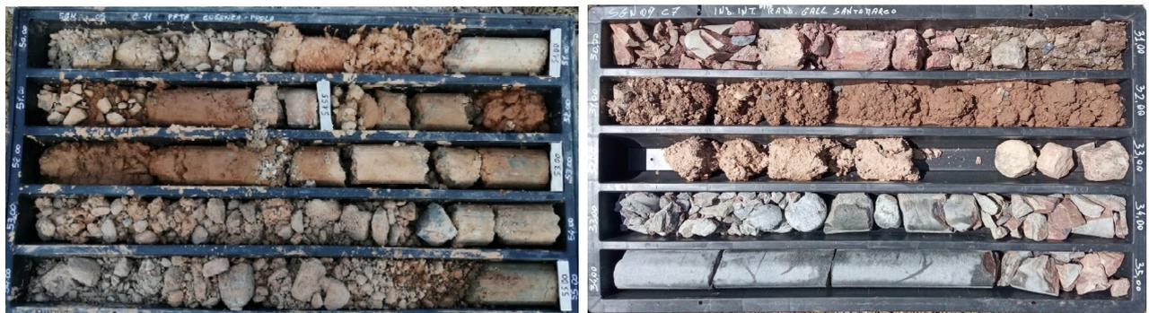
Figura 67 GCL nel foro di sondaggio SGN05 tra 50 e 55 m da p.c. e nel foro di sondaggio SGN09 tra 30 e 35 m da p.c.
