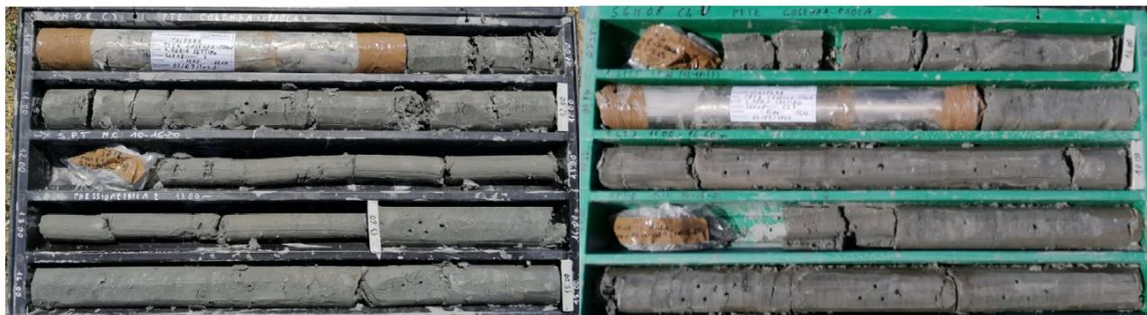
Figura 23 ATS nel foro di sondaggio SGN08 tra 10 e 20 m da p.c.
