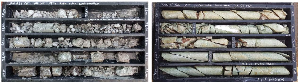
Figura 73 EBG nel foro di sondaggio SGN12 tra 25 e 30 m da p.c. e nel foro di sondaggio SGN12gall tra 10 e 15 m
