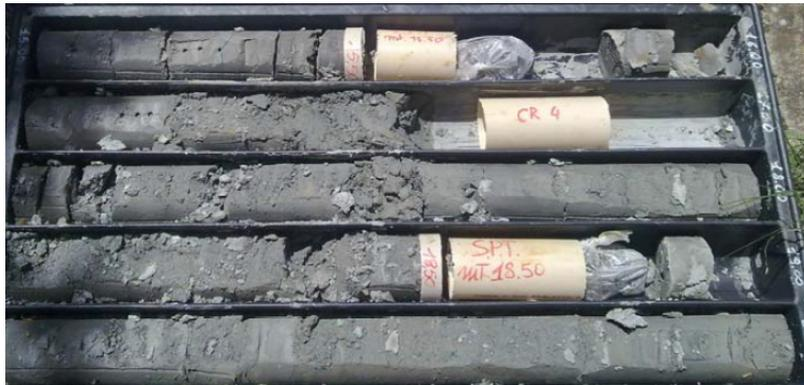
Figura 36 SCM nel foro di sondaggio BH06 tra 15 e 20 m da p.c.
