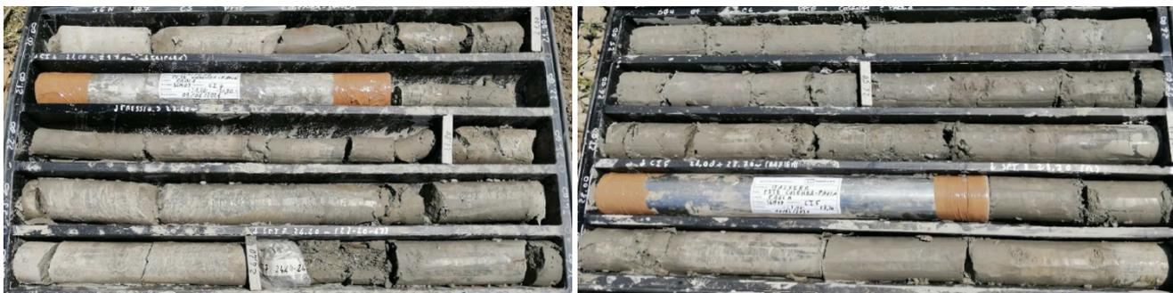
Figura 49 ALD nel foro di sondaggio SGN07 tra 20 e 30 m da p.c.
