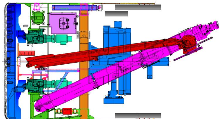
Figura 91 TBM “convertibile” in configurazione da roccia
