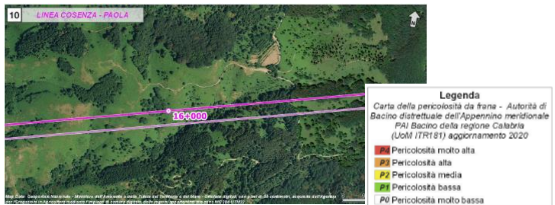
Figura 4-14: Stralcio della "Carta della Pericolosità da frana" del Piano Stralcio di Assetto Idrogeologico della Regione Calabria (PAI 2015 aggiornamento 2020) tratto km 15+000 ÷ 16+700, con individuazione del tracciato ferroviario in progetto (linea magenta).
