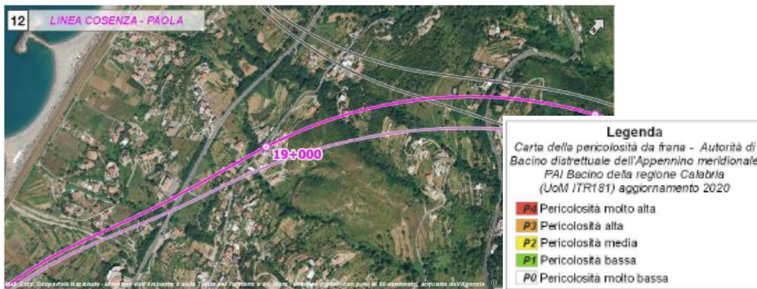
Figura 4-16: Stralcio della "Carta della Pericolosità da frana" del Piano Stralcio di Assetto Idrogeologico della Regione Calabria (PAI 2015 aggiornamento 2020) tratto km 18+300 ÷ 19+800, con individuazione del tracciato ferroviario in progetto (linea magenta).
