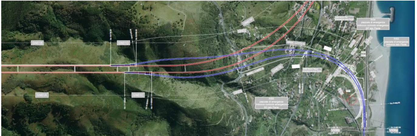
Figura 6 - Stralcio planimetria su ortofoto relativo all'uscita della GN01 lato tirrenico, con indicazione dei cameroni delle interconnessioni per le diramazioni verso Paola
