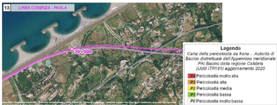
Figura 4-26: Stralcio della “Carta della Pericolosità da frana” del Piano Stralcio di Assetto Idrogeologico della Regione Calabria (PAI 2015 aggiornamento 2020) tratto km 19+000 ÷ 20+500, con individuazione del tracciato ferroviario in progetto (linea magenta).
