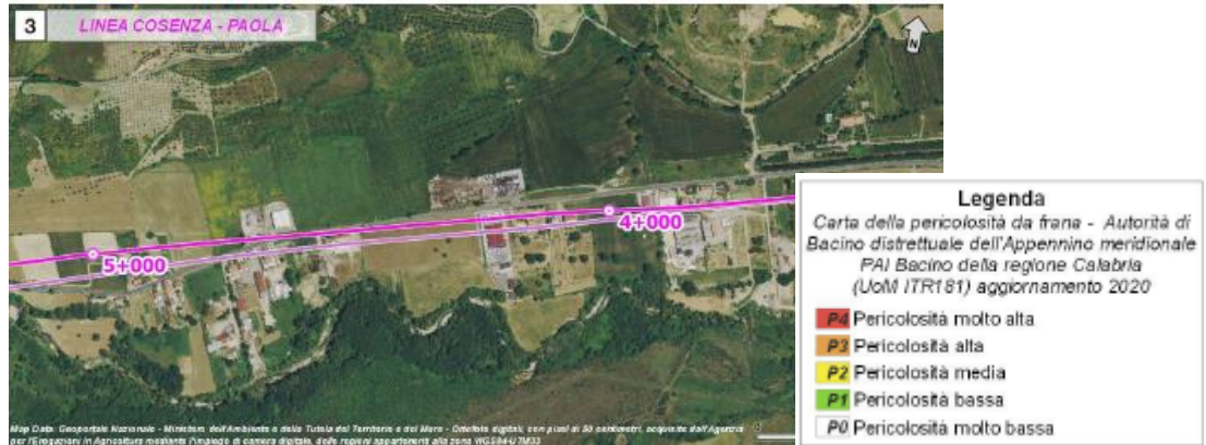
Figura 4-16: Stralcio della “Carta della Pericolosità da frana” del Piano Stralcio di Assetto Idrogeologico della Regione Calabria (PAI 2015 aggiornamento 2020) tratto km 3+600 ÷ 5+100, con individuazione del tracciato ferroviario in progetto (linea magenta)
