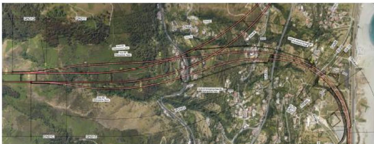
Figura 4-3: Stralcio planimetria su ortofoto relativo all'uscita della GN01 lato tirrenico, con indicazione dei camerone delle interconnessioni per le diramazioni verso Paola
