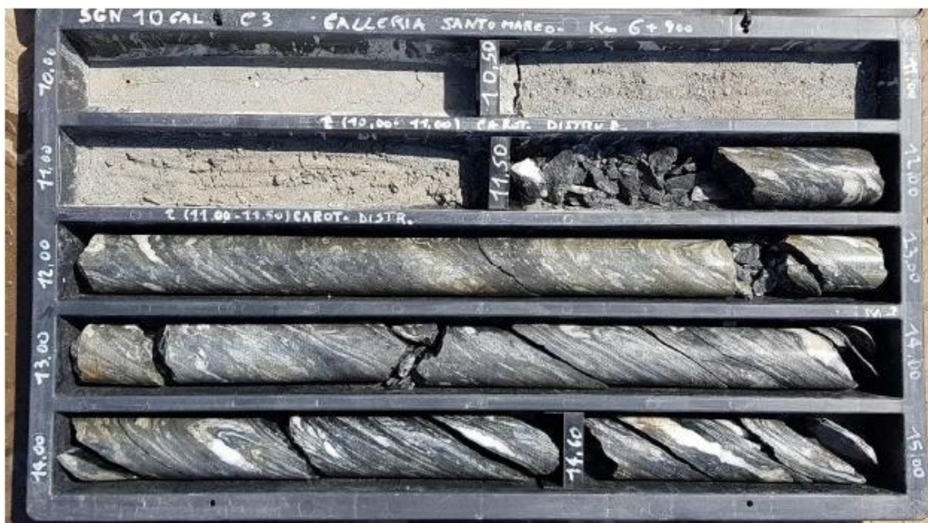
Figura 8 – Filladi fratturate nel sondaggio SGN10 GAL, tra 10.0 e 15.0 m.
