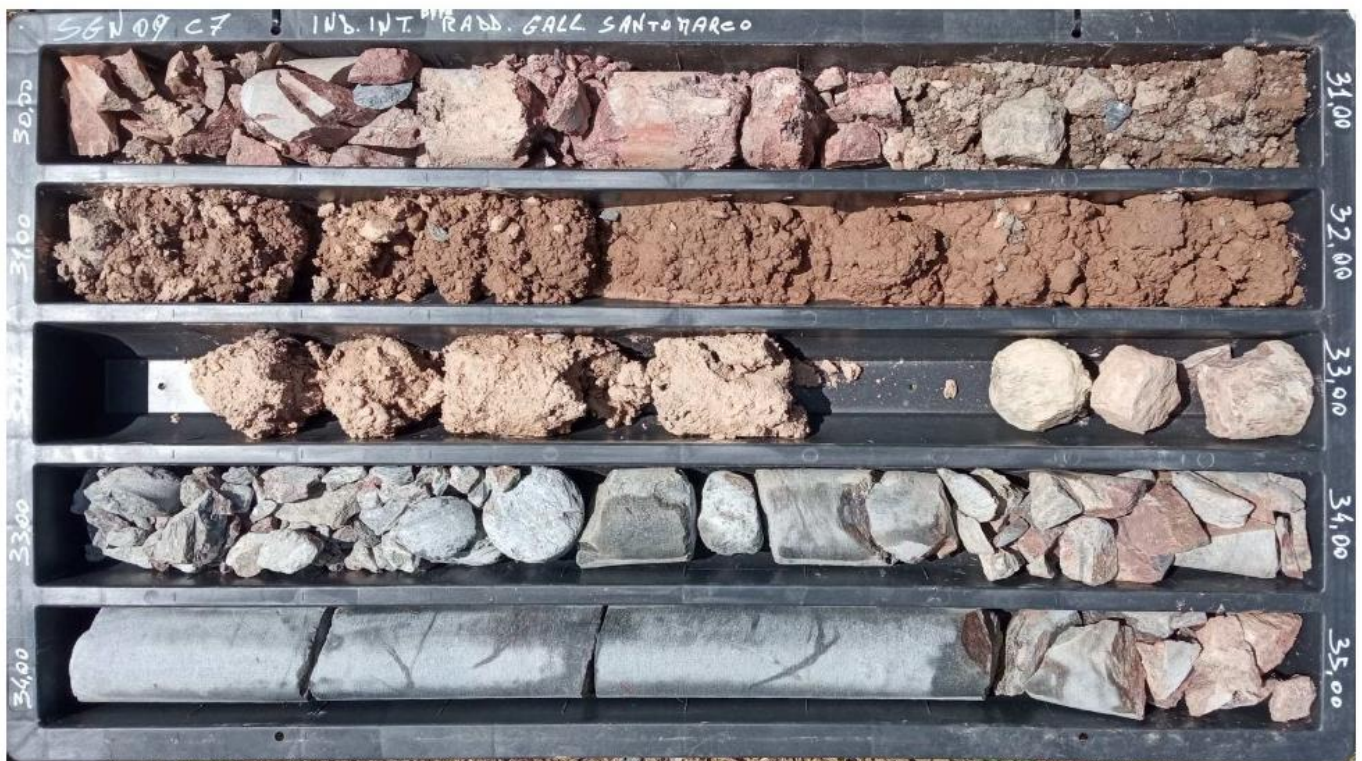
Figura 3 – Gneiss fratturati nel sondaggio SGN09, tra 30.0 e 35.0 m.
