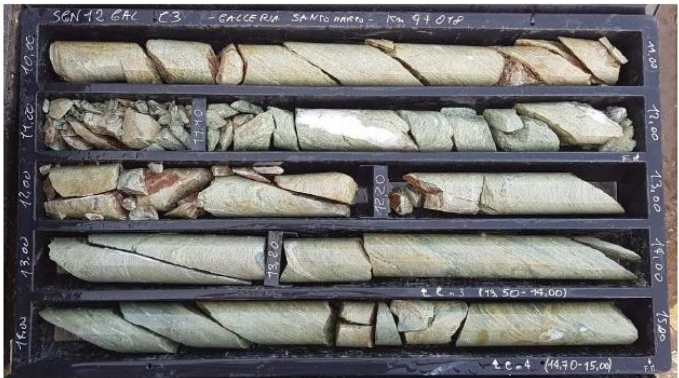
Figura 4 – Scisti epidotici fratturati nel sondaggio SGN12 GAL, tra 10.0 e 15.0 m.
