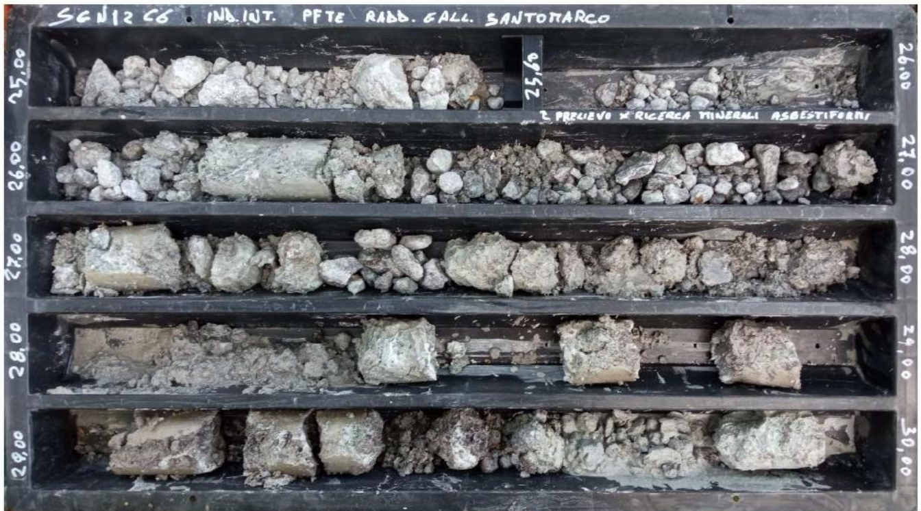
Figura 5 – Scisti epidotici tettonizzati nel sondaggio SGN12, tra 25.0 e 30.0 m.
