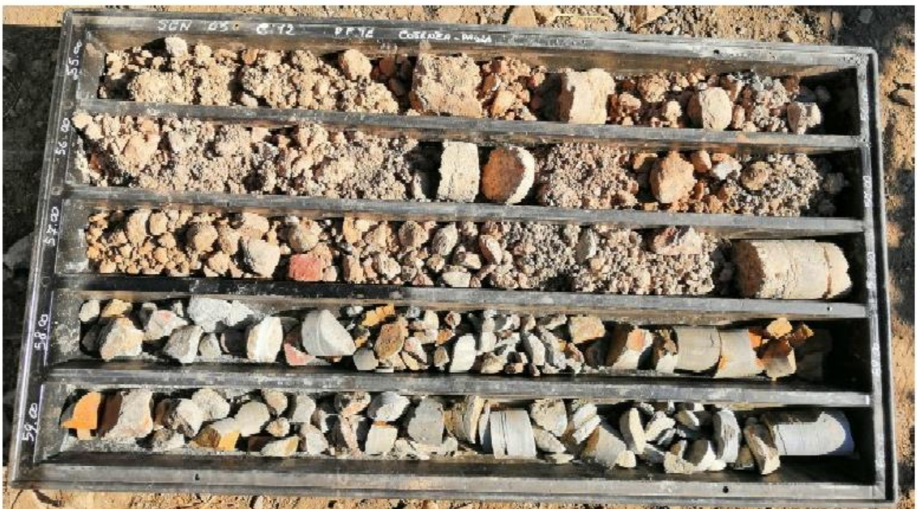
Figura 2 – Gneiss fratturati nel sondaggio SGN-05, tra 55.0 e 60.0 m.
