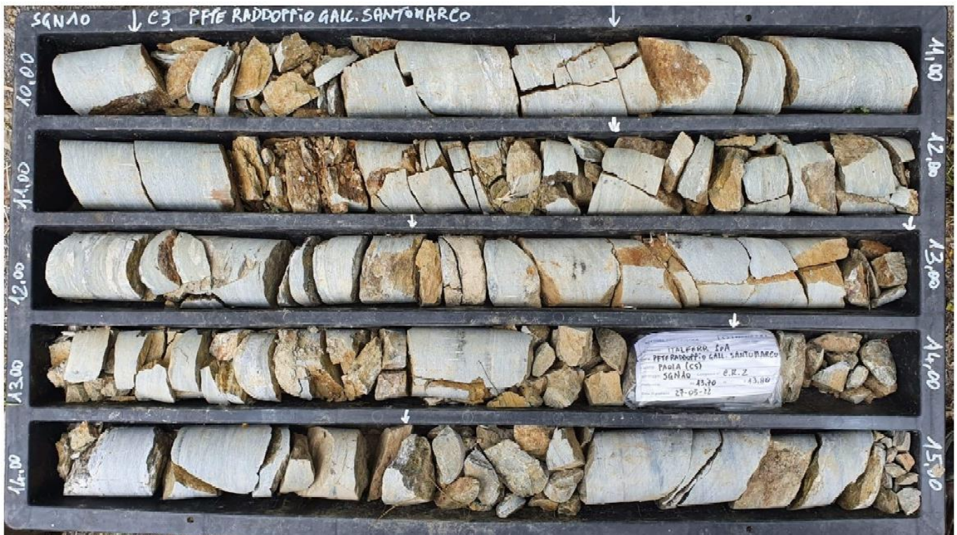
Figura 6 – Scisti muscovitici fratturati nel sondaggio SGN10, tra 10.0 e 15.0 m.
