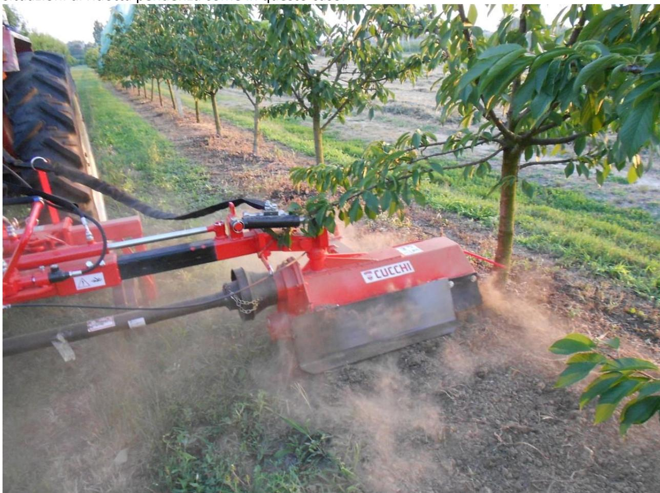
**Figura 18 – esempio di fresatrice interceppo in azione in un frutteto (<https://www.cucchi-ma.it>)**
