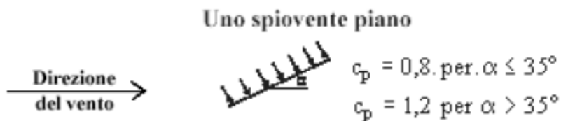
Fig. 4 - Definizione dei coefficienti di pressione
