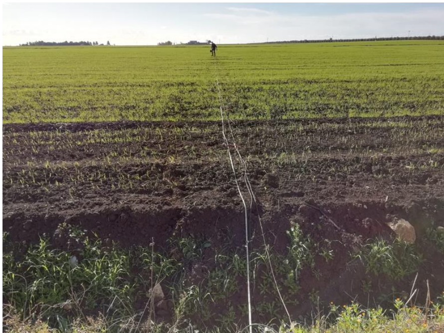
Esecuzione indagine Masw sullo stesso stendimento 3-3' in AREA A
