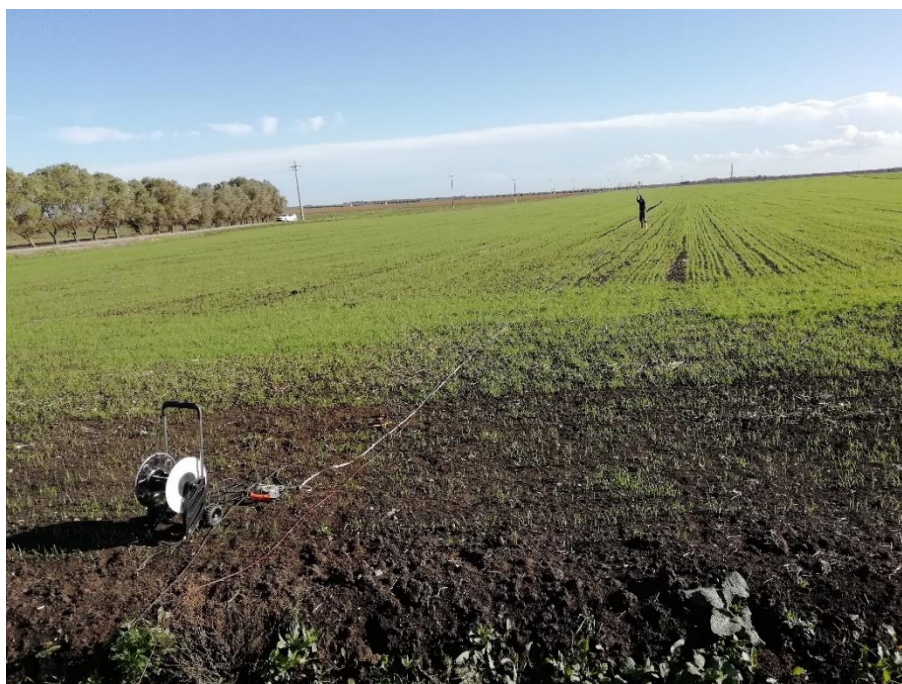
Esecuzione indagine sismica a rifrazione n. 2-2' in AREA A
