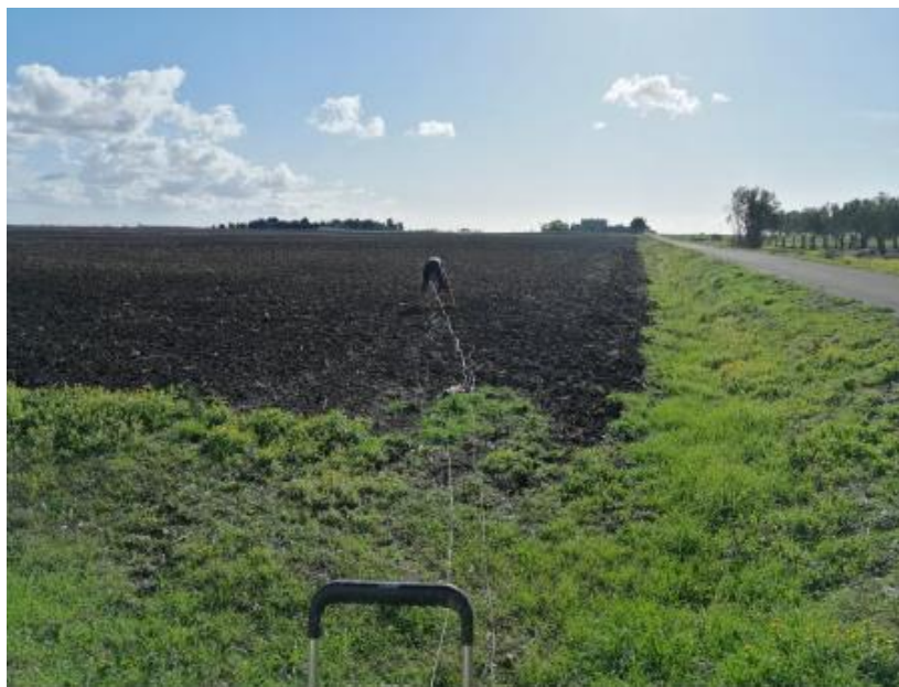
Esecuzione indagine Masw sullo stesso stendimento 1-1' in AREA B
