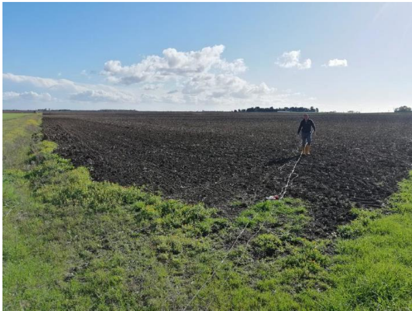
Esecuzione indagine sismica a rifrazione n. 1-1' in AREA B
