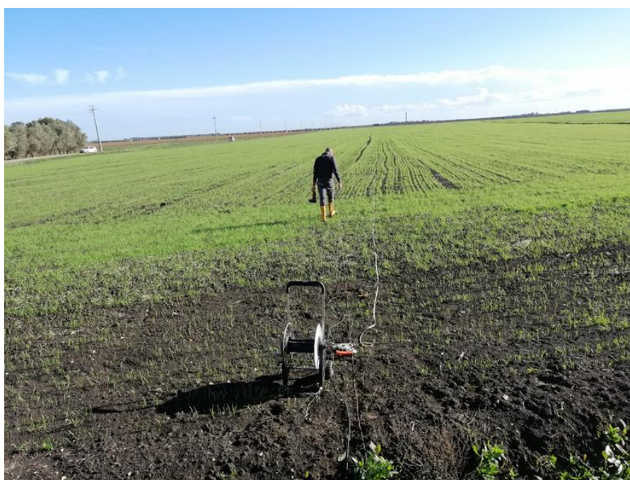
Esecuzione indagine Masw sullo stesso stendimento 2-2' in AREA A
