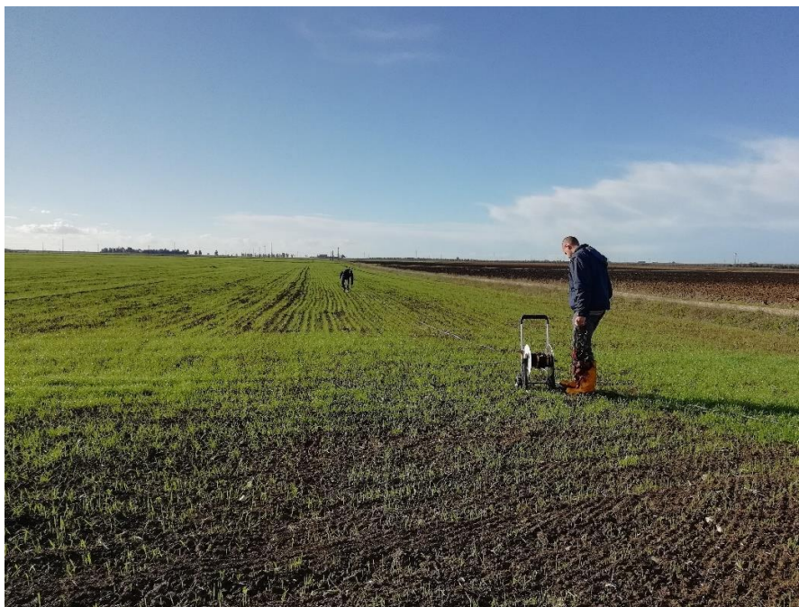
Esecuzione indagine sismica a rifrazione n. 1-1' AREA A
