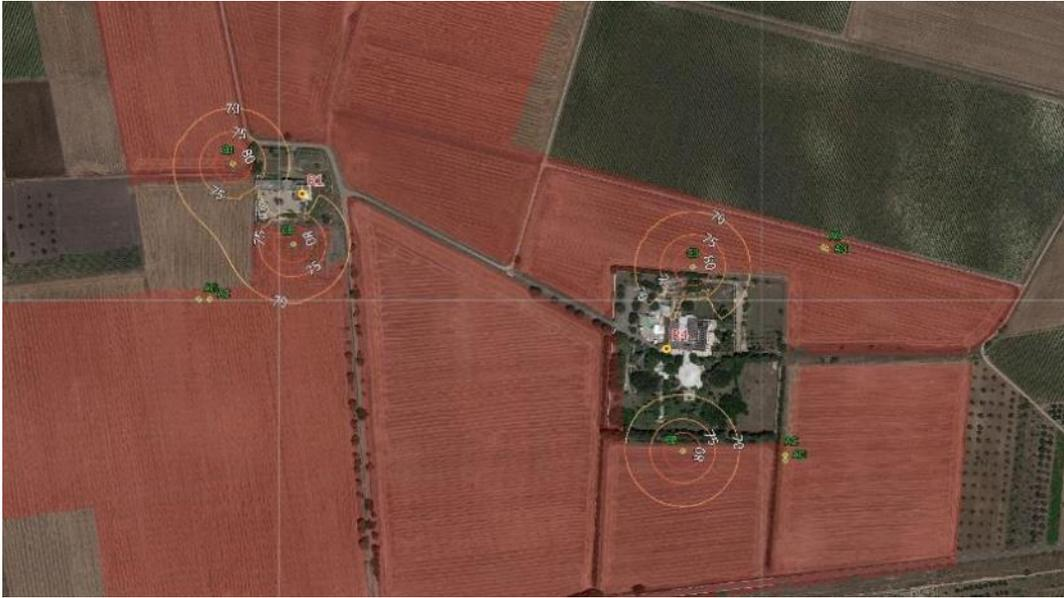
Figura 35 – Calcolo delle isofone nello scenario di cantiere Fase 7 ipotizzando l'impiego del cingolato battipalo (CB) nelle posizioni più critiche rispetto ai recettori R1 e R4
