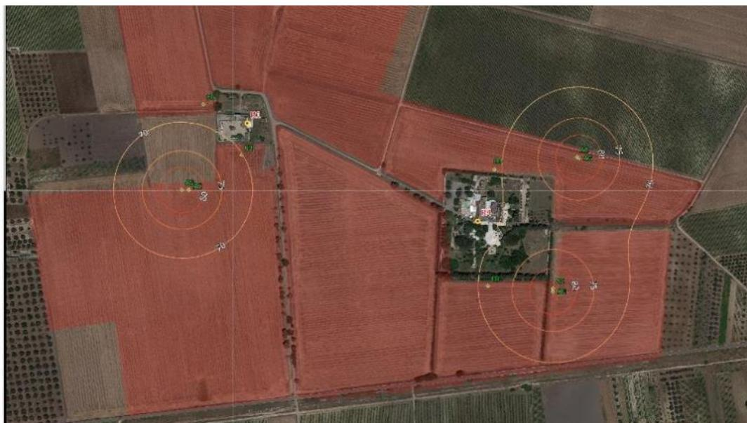
Figura 36 - Calcolo delle isofone nello scenario di cantiere Fase 6 durante la posa delle cabine ipotizzando l'impiego contemporaneo di autogru (AG) e autocarro(AC) nelle posizioni più critiche rispetto ai recettori R1 e R4
