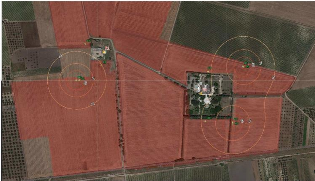
Figura 152: Calcolo delle isofone nello scenario di cantiere Fase 6 durante la poa delle cabine ipotizzando l'impiego contemporaneo di autogru (AG) e autocarro (AC) nelle posizioni più critiche rispetto ai recettori R1 e R4
