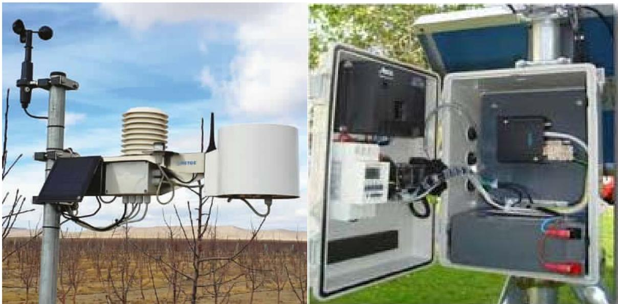
Figure 19 e 20 – a sinistra, una centralina agrometeorologica completa di pluviometro, termoigrometro, anemometro e radiometro; a destra, unità di gestione dell'irrigazione con PLC, datalogger, modulo GSM, e moduli attuatori di comando delle elettrovalvole.
