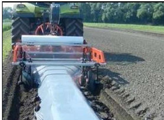
Figura 14 – Pacciamatura sulla baulatura con apprestamento del film plastico e sua rinalzata eseguite meccanicamente.
