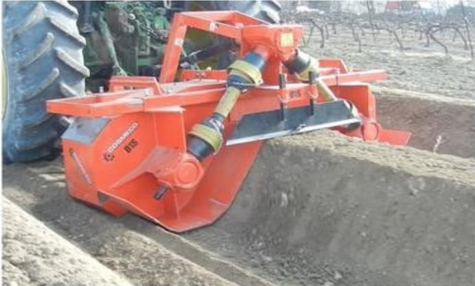
*Figura 12 – Realizzazione meccanica della baulatura del sottofilare*
