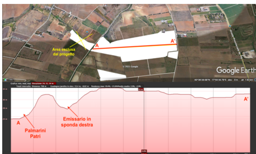
Tavola n. 17: sezione longitudinale con evidenziata la vallecola imbriferà.
