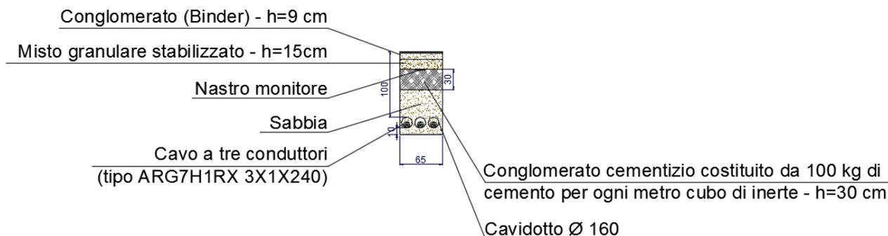
La canalizzazione del cavidotto avverrà rispettando le distanze dai sotto-servizi presenti, in conformità con quanto previsto nelle LINEE GUIDA Nazionali.
