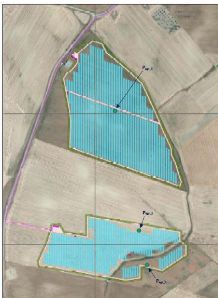
Figura 14.4 – Planimetria dell'impianto con indicazione dei punti di campionamento per il monitoraggio del suolo agricolo
