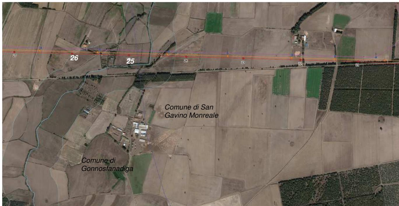
Fig. 3: Estratto elaborato progettuale, in rosso il nuovo tracciato dell'elettrodotto a 150kV "Villacidro-Guspini", in giallo il tracciato oggetto di demolizione che nei comuni di Gonnosfanadiga e di San Gavino Monreale attraversa la fascia di rispetto del Riu Trottu in cui ricadono i nuovi sostegni 25 e 26.
