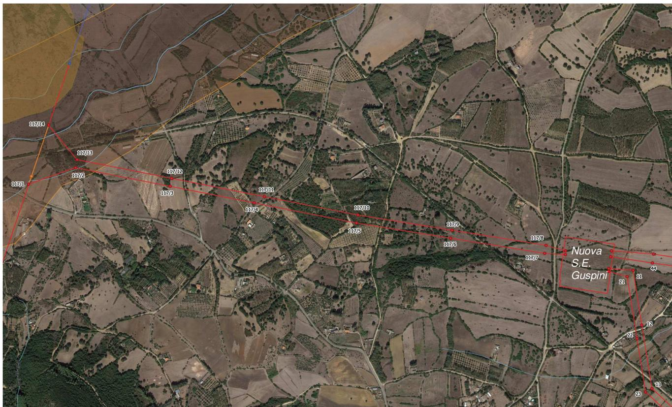
Fig. 5: Estratto elaborato progettuale, comune di Guspini, parte dei raccordi aerei a 220kV per inserire in entra-esce la nuova SE nella linea a 220kV "Oristano-Sulcis" che ricadono nell'area tutelata del Riu Montevecchio-Sitzerri.
