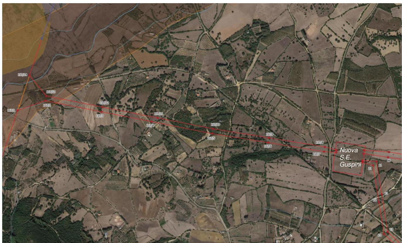
Fig. 6: Estratto elaborato progettuale, comune di Guspini, parte dei raccordi aerei a 220kV per inserire in entra-esce la nuova SE nella linea a 220kV "Oristano-Sulcis" che ricadono nell'area tutelata del Riu Montevecchio-Sitzerri.
