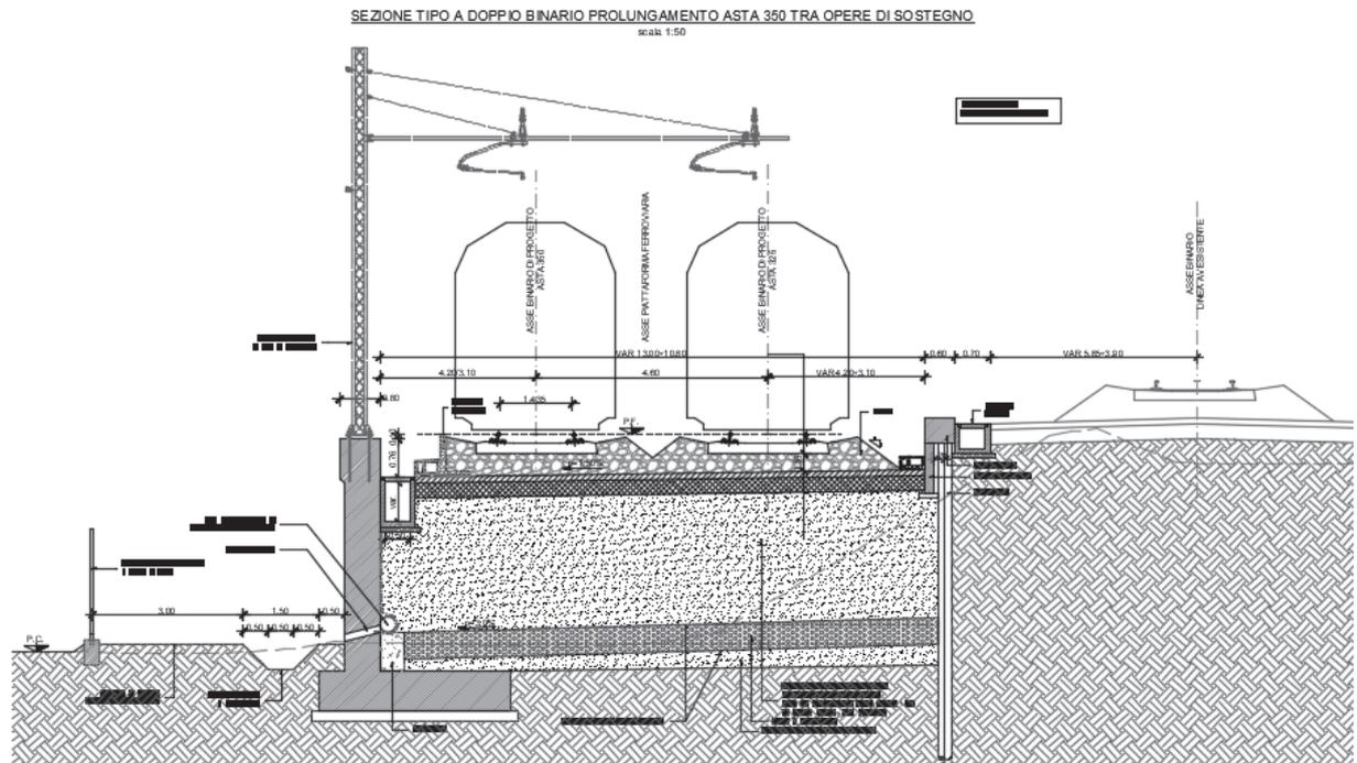
Figura 6 - Sezione tipo DB in rilevato in affiancamento alla linea AV/AC esistente con paratia di micropali lato linea AV/AC e muro di sostegno- aste L=350m
