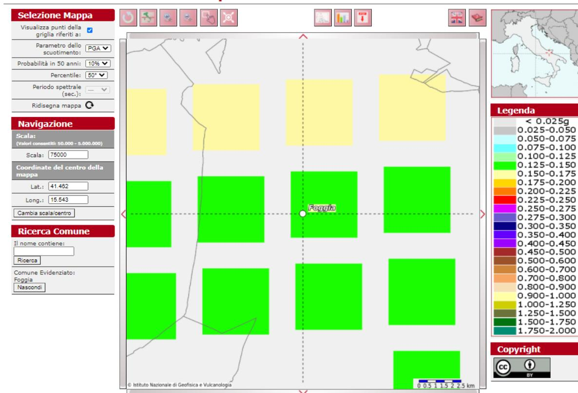
**Figura 12 - Mappa di pericolosità sismica del territorio nazionale espressa in termini di accelerazione massima al suolo ( $a_{max}$ ) con probabilità di eccedenza del 10% in 50 anni riferita a soli molto rigidi ( $V_{s30} > 800$  m/s; cat.A). Fonte: [http:// esse1-gis.mi.ingv.it/](http://esse1-gis.mi.ingv.it/).**
