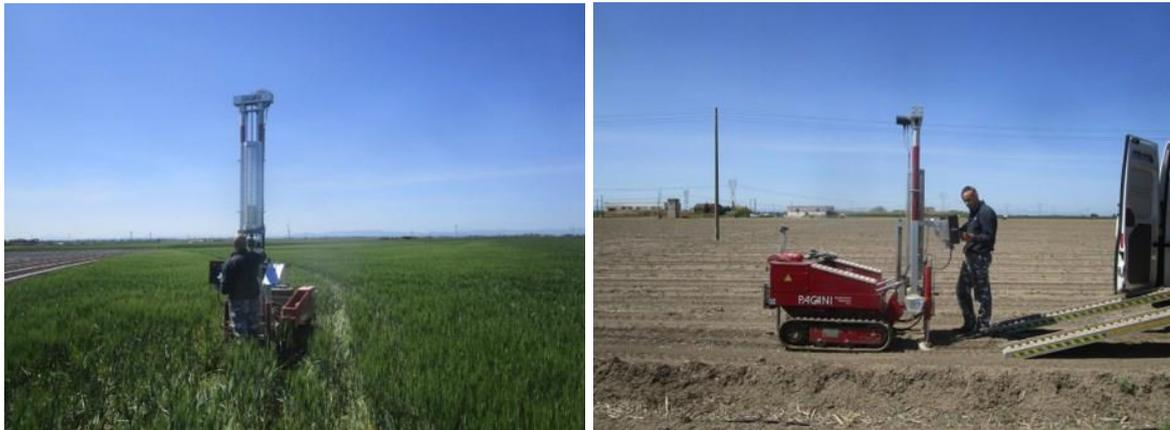
**Figura 11 - Esecuzione prove penetrometriche dinamiche DPSH.**
