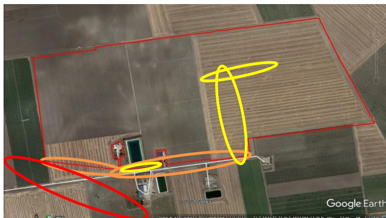
Figura 23: AREA A SUD - Linee elettriche nell'area d'impianto: BT (cerchi in giallo), MT (cerchi in arancione) e, appena fuori, a sud-ovest, linea AT (cerchio in rosso)
