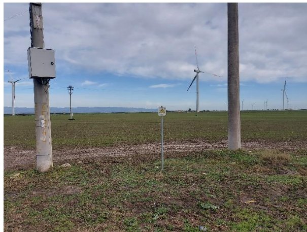
Figura 43: Punto 002 - paletto che informa di un sottoservizio con cavo in tensione a 30 kV
