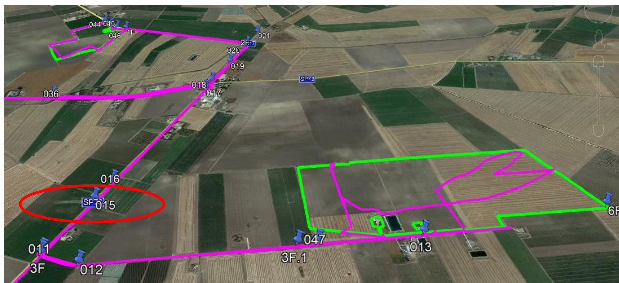
Figura 29: Percorso del cavidotto e cerchio rosso nel punto 015 per attraversamento stradale grandi tubi
