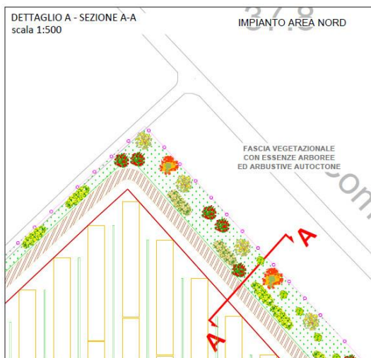
Figura 75 Vista planimetrica e vista in sezione della piantumazione degli asparagi tra le file dei tracker
