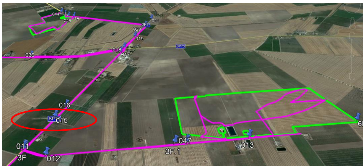
Figura 20: Percorso del cavidotto e cerchio rosso nel punto 015 per attraversamento stradale grandi tubi
