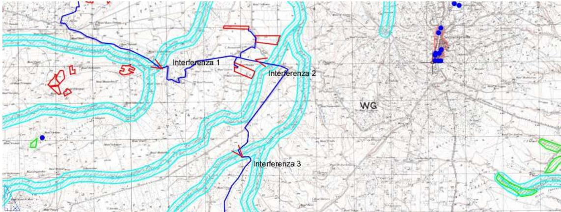
Sarà effettuato attraversamento degli stessi con posa del cavidotto MT in sub-alveo mediante trivellazione orizzontale controllata. Il cavidotto MT sarà quindi completamente interrato (non staffato a ponte) e non visibile all'occhio umano. Tale operazione consente di apportare benefici qualitativi in termini di impatti paesaggistici, di esondazione dei corsi d'acqua, permettendo inoltre la riduzione dell'inquinamento elettromagnetico.
