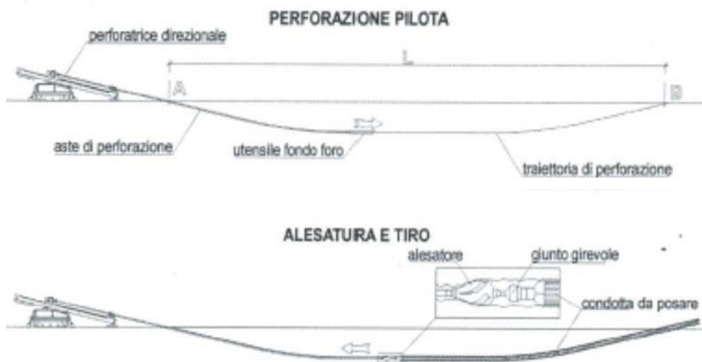
Schema semplificato del sistema di trivellazione T.O.C.
