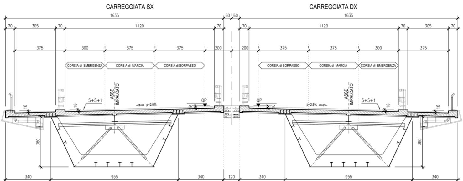
**FIGURA 3-3: SEZIONE TRASVERSALE TIPICA.**
