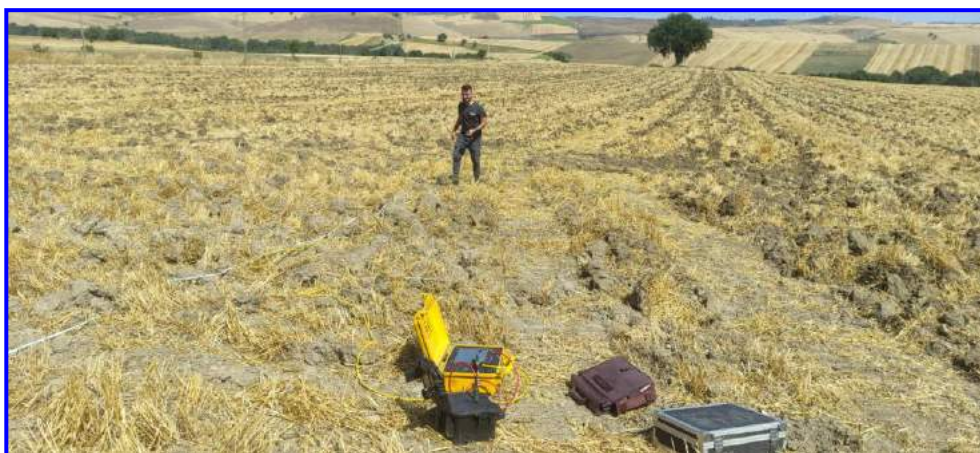
Fig. 1 – Prospezione sismica MASW n.3 effettuata in area progettuale.
