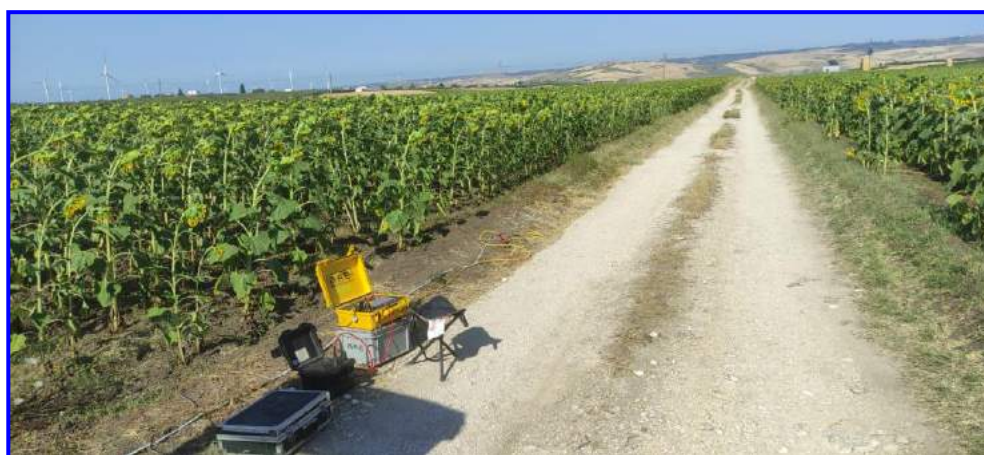
Fig. 1 – Prospezione sismica MASW effettuata in area progettuale.
