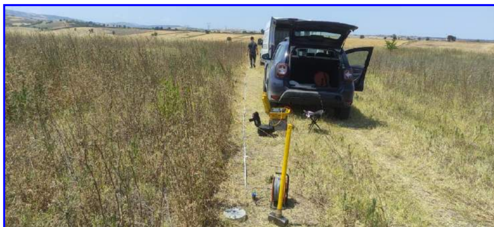
Fig. 1 – Prospezione sismica MASW n.5 effettuata in area progettuale.
