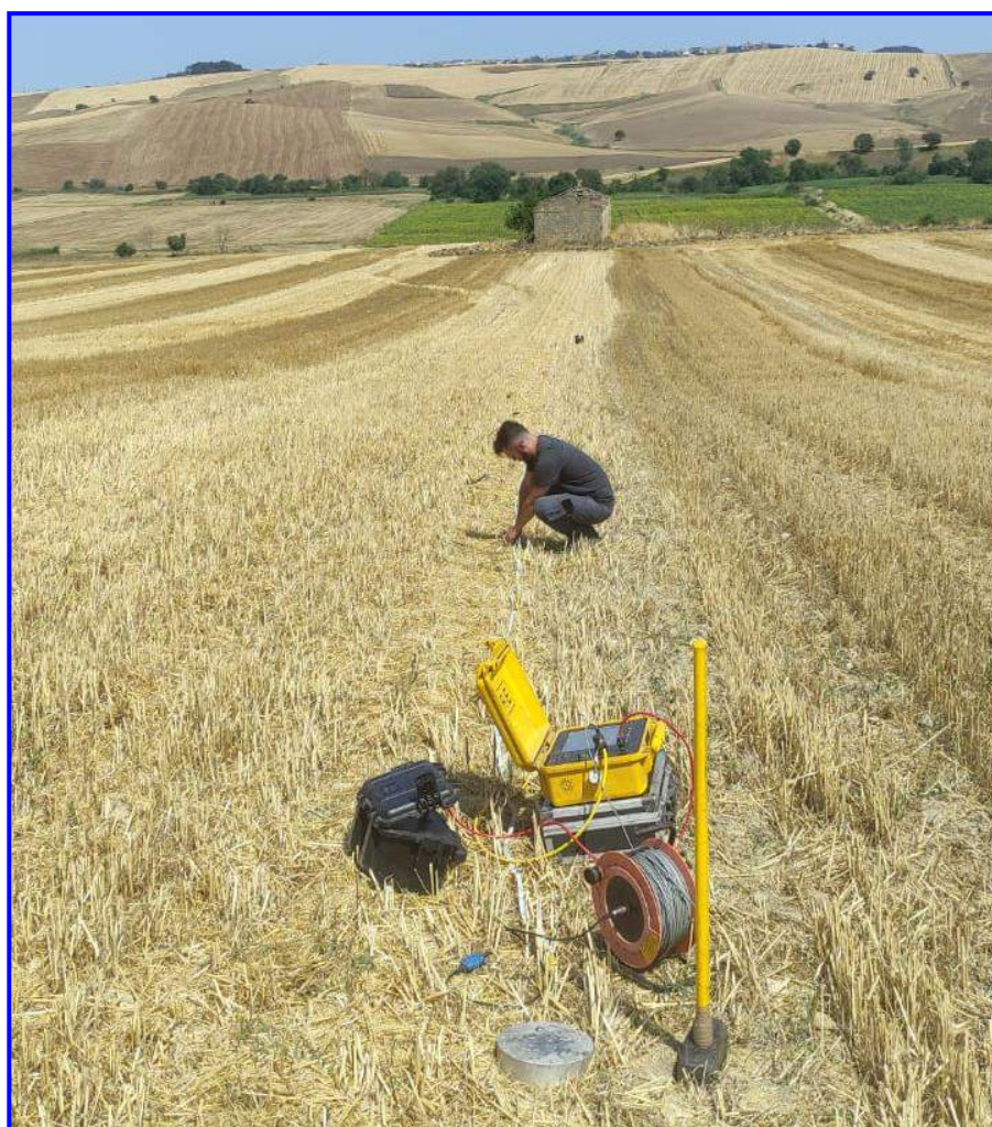
Fig. 1 – Prospezione sismica MASW n.4 effettuata in area progettuale.
