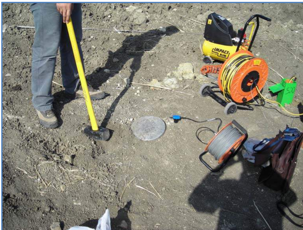
Fig. 6 – Sorgente energizzate, costituita da massa battente su piastra di alluminio.
