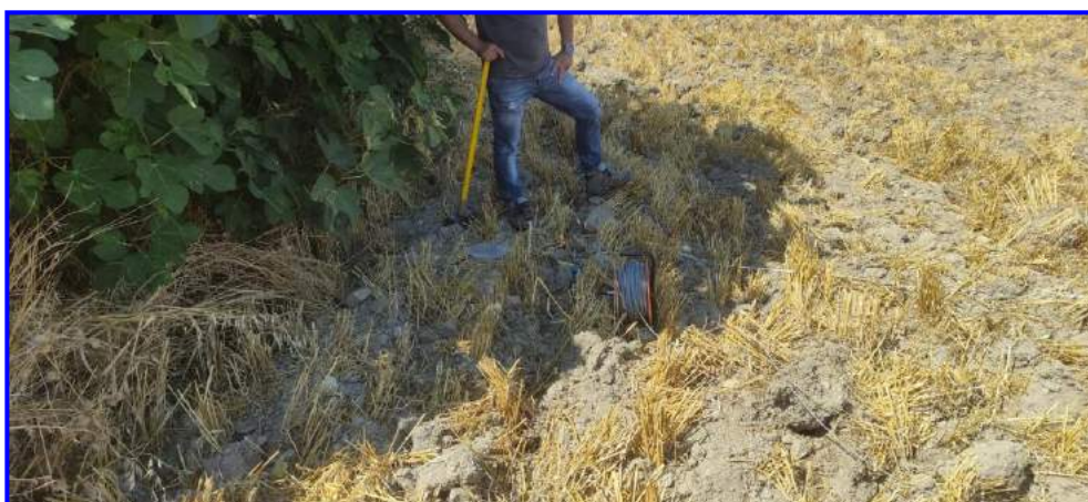
Fig. 3 – Sorgente energizzante, costituita da massa battente su piastra di alluminio. Come starter/trigger è stato utilizzato un geofono verticale Geospace a 14Hz.
