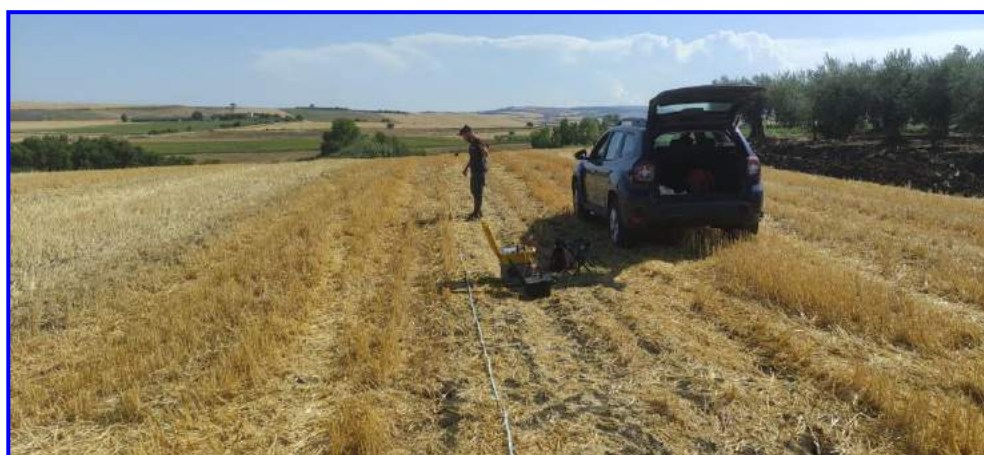
Fig. 1 – Prospezione sismica MASW n.2 effettuata in area progettuale.
