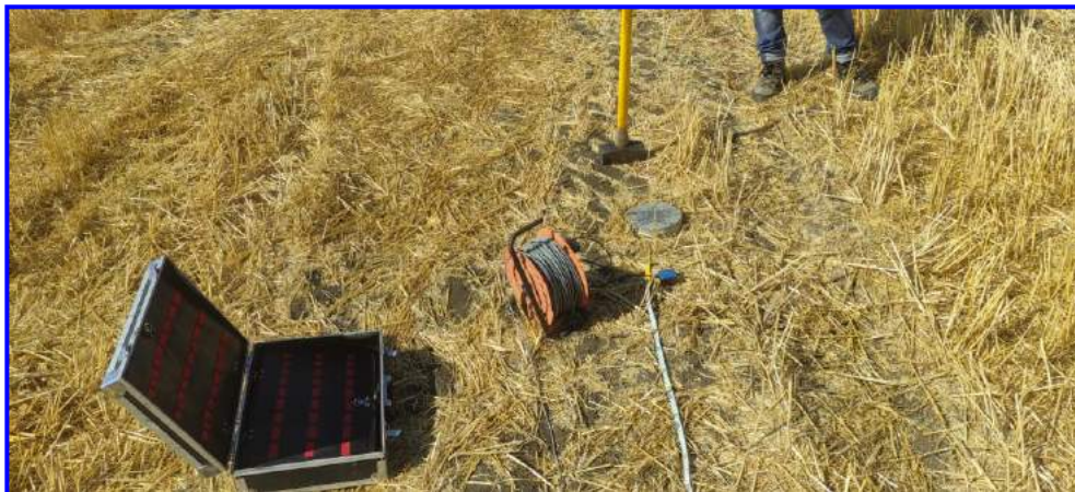
Fig. 3 – Sorgente energizzante, costituita da massa battente su piastra di alluminio. Come starter/trigger è stato utilizzato un geofono verticale Geospace a 14Hz.
