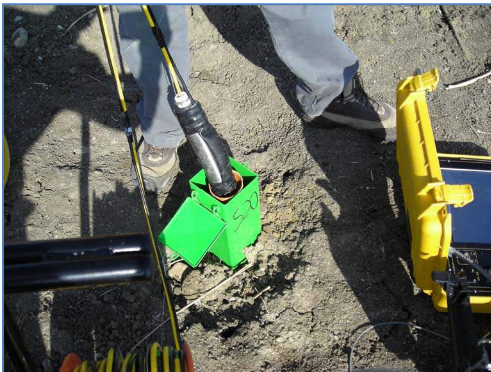
Fig. 7 – Sonda geofonica da foro a tre componenti (3 geofoni Geospace a 4.5Hz).
