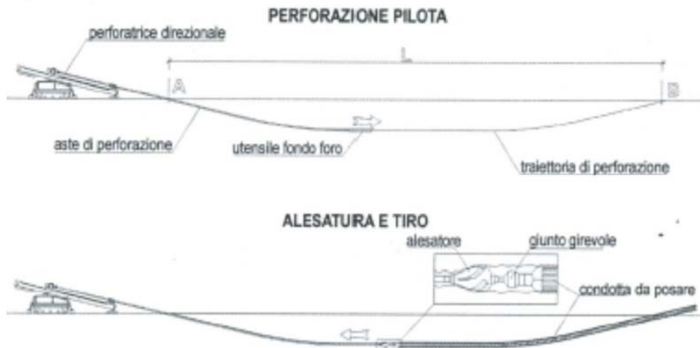
Schema semplificato del sistema di trivellazione T.O.C.
