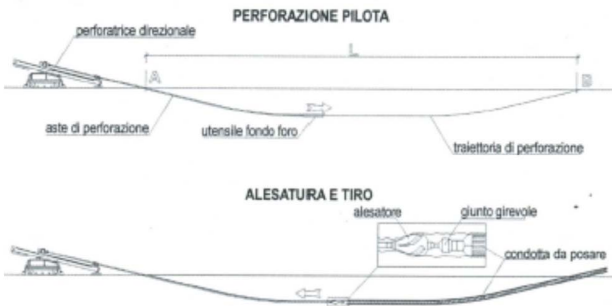
Schema del sistema T.O.C. – Trivellazione Orizzontale Controllata
