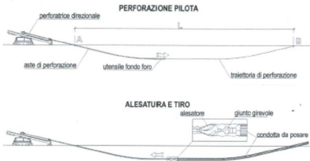
Schema semplificato del sistema di trivellazione T.O.C.
