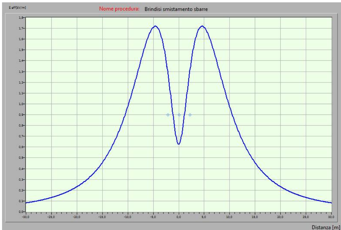
Fig. 6 Profilo laterale campo elettrico (E) sbarre 150 kV
