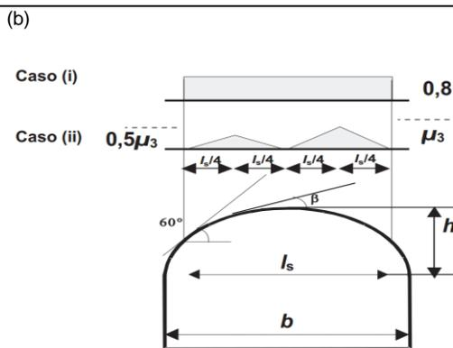
(c) Coefficienti di forma e relative combinazioni di carico per la neve: (a) coperture ad una falda [cfr. 3.4.5.2 D.M. 2018], (b) coperture a due falde [cfr. 3.4.5.3 D.M. 2018], (c) coperture a più falde [cfr. C3.4.3.3 Circolare 2019 n. 7], (d) coperture cilindriche [cfr. C3.4.3.3.1 Circolare 2019 n. 7].
