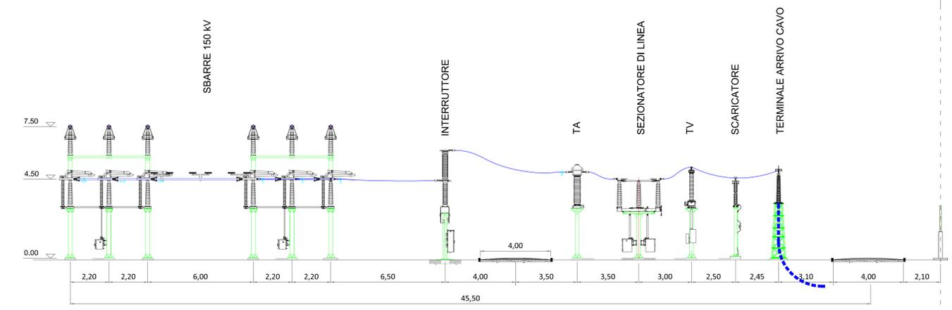
SEZIONE STALLO ARRIVO CAVO PRODUTTORE 150 kV - SCALA 1:100
