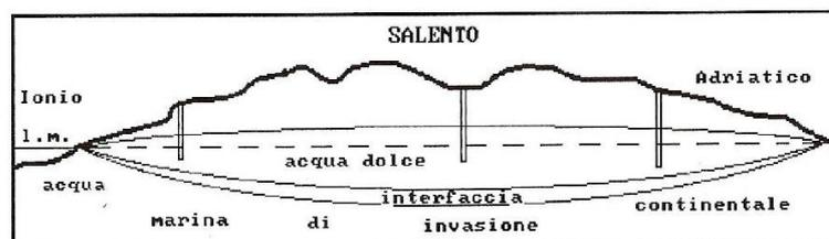
**FIG 9** - Sezione idrogeologica schematica della Penisola Salentina
