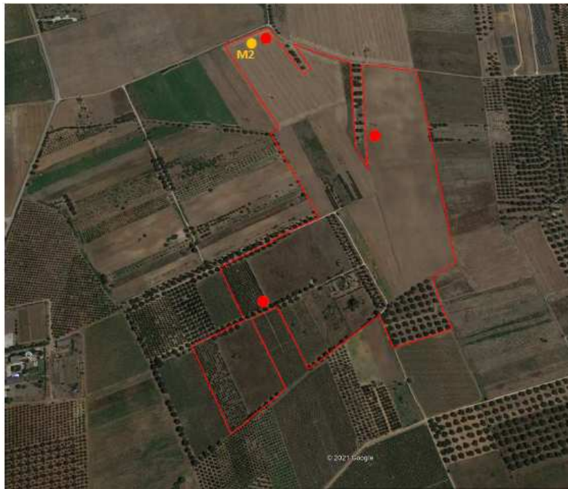
Indicazione dei ricettori (pallini azzurri), delle cabine di trasformazione BT/MT (pallini rossi), dei punti di misurazione di Leq(A) (pallini gialli)
