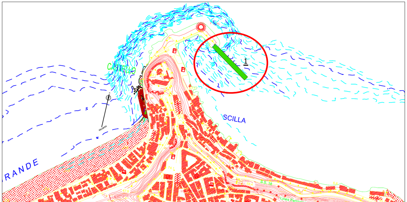
Figura 3.7 Intervento di prolungamento del Molo Foraneo del tratto SCI-1 e SCI-2 del comune di Scilla [Fonte: Masterplan degli interventi di mitigazione del rischio di erosione costiera in Calabria ]
