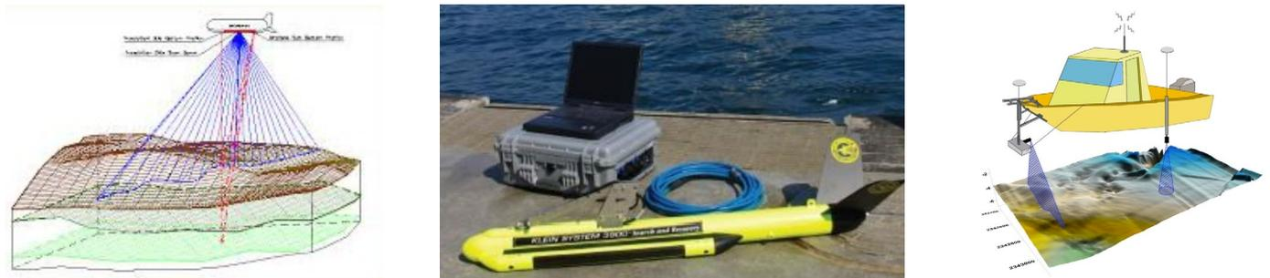
Figura 5.3 Strumentazione utilizzata per il rilievo morfologico dei fondali: Side Scan Sonar e Multibeam.
