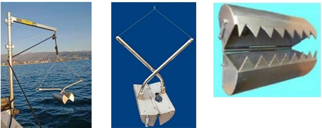
Figura 5.2 Strumentazione utilizzata per il campionamento dei sedimenti marini: Benna standard e benna dentata.
