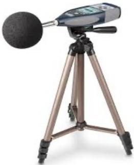
**Figura 5.4** Strumentazione utilizzata per il monitoraggio acustico: fonometro.
