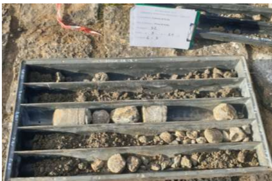
Fotografia 5 - Sondaggio S2, cassetta n.2
