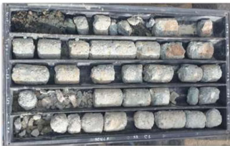
Fotografia 7 - Sondaggio S3. Casseta n. 1 da 0,00 a 6,00 mt
