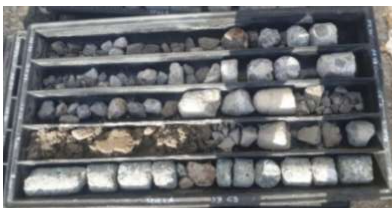
Fotografia 8 - Sondaggio S3. Casseta n. 2 da 6,00 a 12,00 mt
