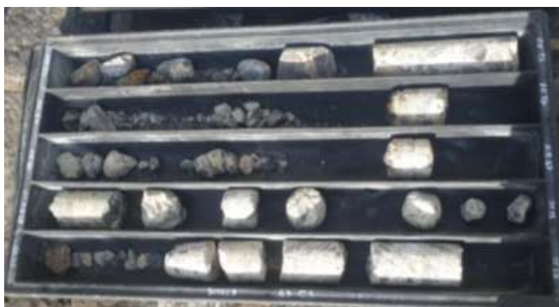
Fotografia 9 - Sondaggio S3. Cassetta n. 3 da 12,00 a 14,00 mt
