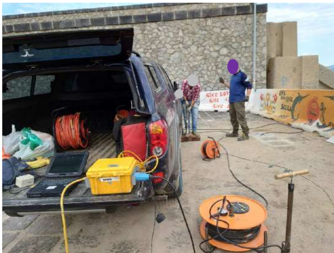
Foto 1. Prospezione sismica in foro Down-Hole (DH_S1)
