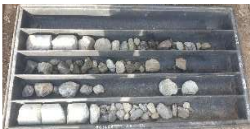
Fotografia 10 - Sondaggio S3. cassetta n. 4 da 14,00 a 20 mt
