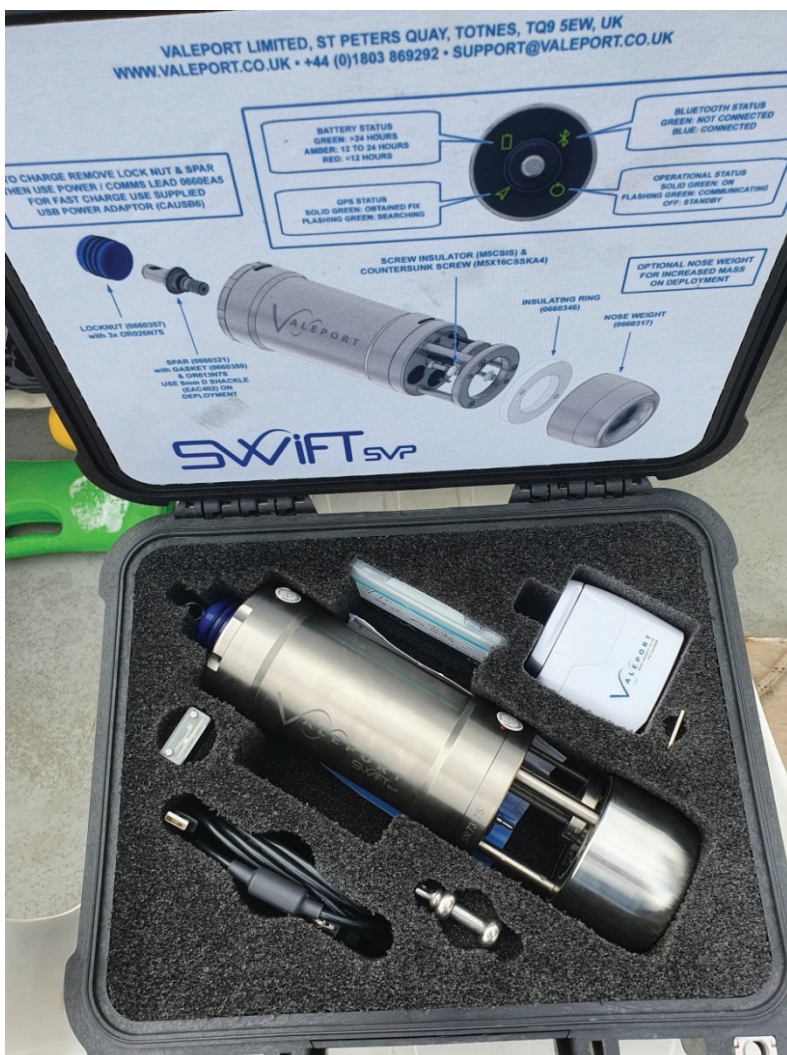
Fig. 10 - Sonda multiparametrica Valeport Swift SVP utilizzata per la misurazione della velocità del suono in acqua
