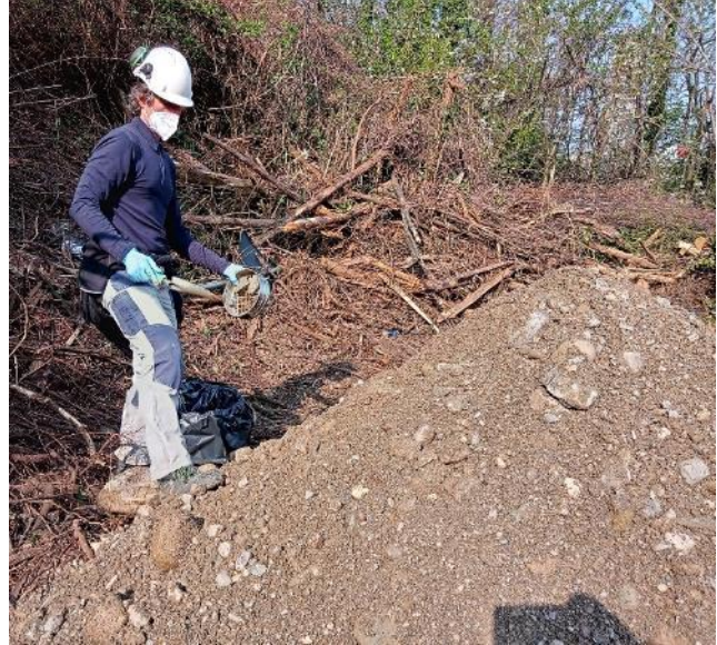
Figura 7.1/C sinistra fase di omogenizzazione e formazione campioni; A Destra il prelievo e la setacciatura in cumulo.
