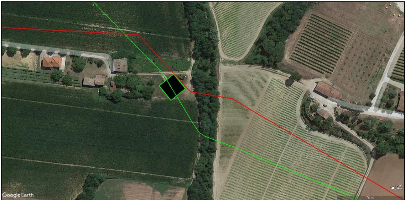
Figura 1.2/E – Tracciato in corrispondenza del due rami del T. Soara (in rosso condotta in progetto in verde condotta in dismissione) pk 24+721
