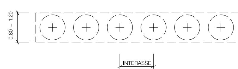
SEZIONE TIPO TRAVE DI COLLEGAMENTO
