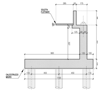
SEZIONE TRASVERSALE SPALLA B
