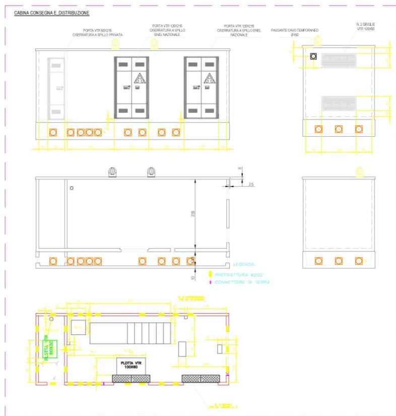
Figura 3.7: Cabina di Consegna E-Distribuzione
