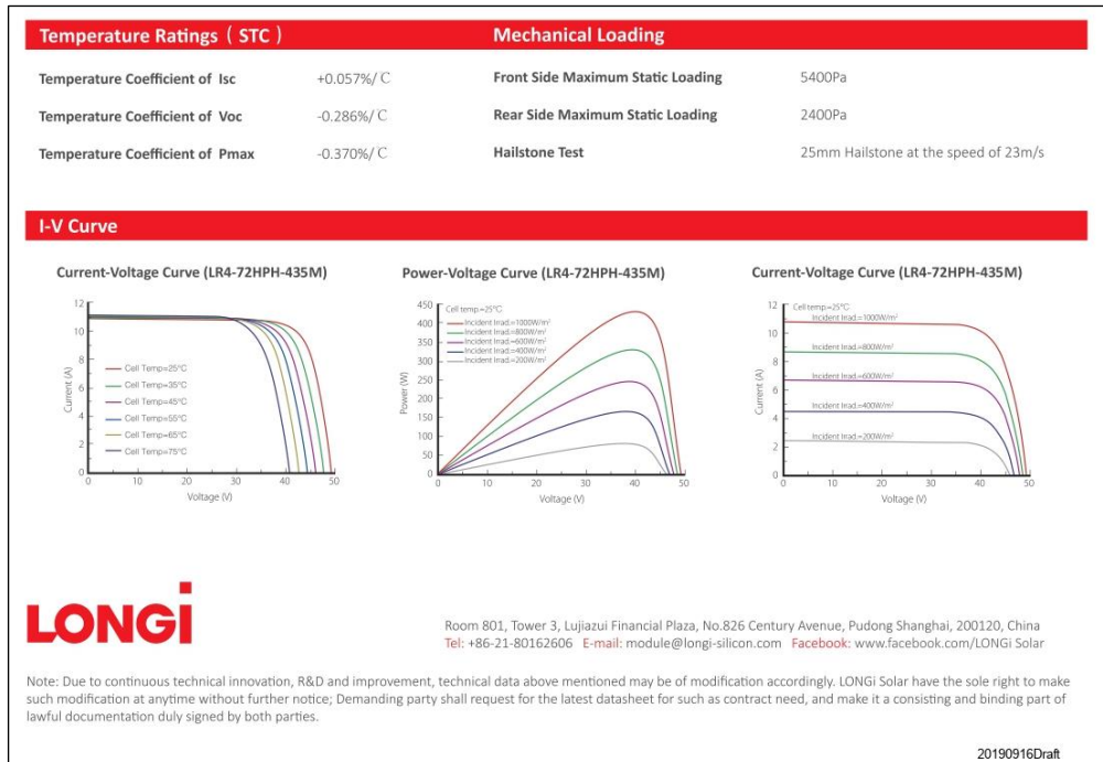
Figura 3.5: Caratteristiche Elettriche del Modulo
